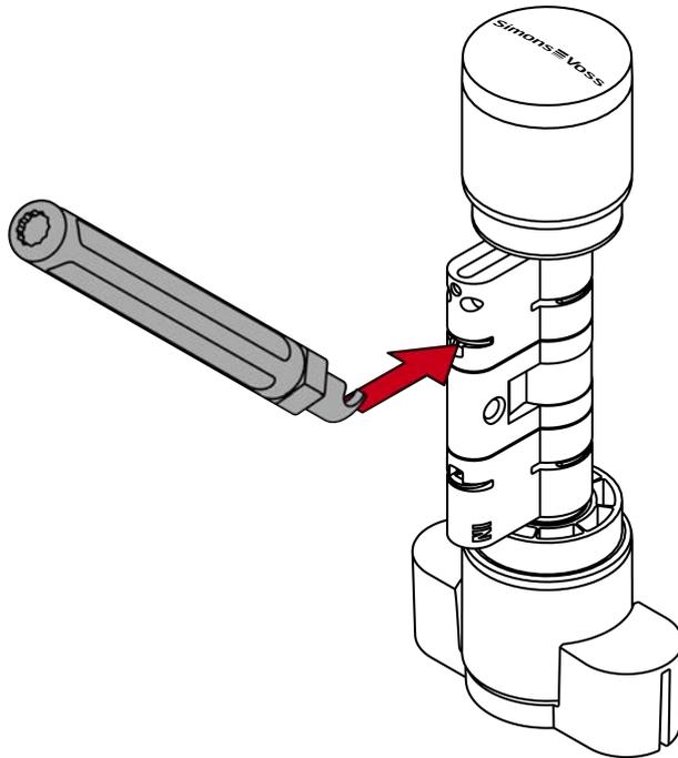
3. Hebeln Sie die Klammer aus dem Profilzylinder, indem Sie den Ausheber in die Mitte des Zylinders bewegen.
