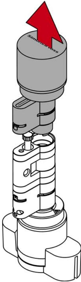
6. Schrauben Sie mit dem Ausheber den Bolzen heraus.
