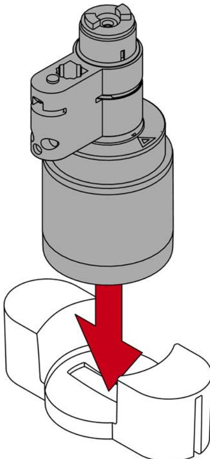
9. Setzen Sie das Halbzyylinder-Mittelstück auf die vorbereitete Zylinderhälfte.
