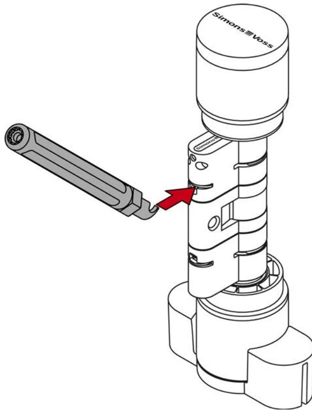
3. Hebeln Sie die Klammer aus dem Profilzylinder, indem Sie den Ausheber in die Mitte des Zylinders bewegen.
