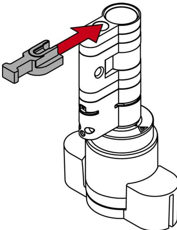
10. Schrauben Sie mit dem Ausheber einen passenden Verlängerungsbolzen ein, bis er am Abstandshalter anliegt.
