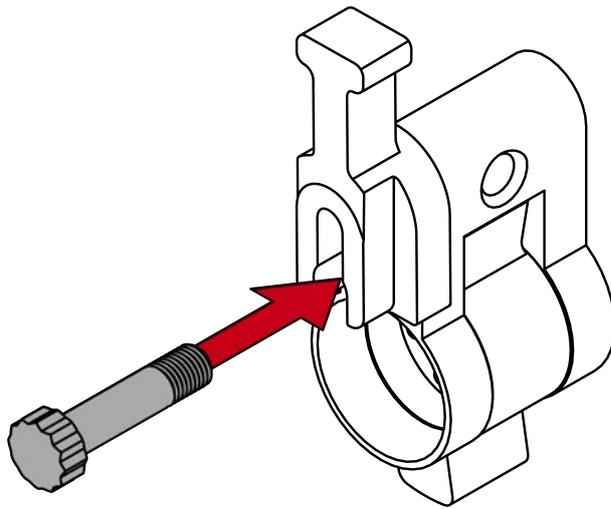
14. Stecken Sie eine Zylinderhälfte auf den Verlängerungsbolzen.
