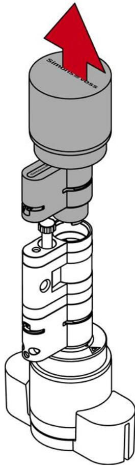
6. Schrauben Sie mit dem Ausheber den Verlängerungsbolzen heraus.
