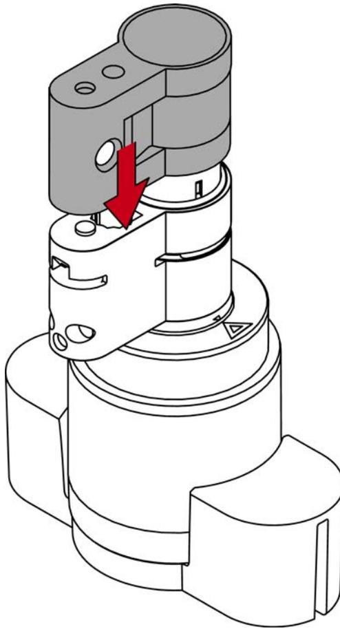
12. Setzen Sie die Klammer mit der Nase zur Stulpschraube wieder in den Schlitz des Profilzylinders ein.
