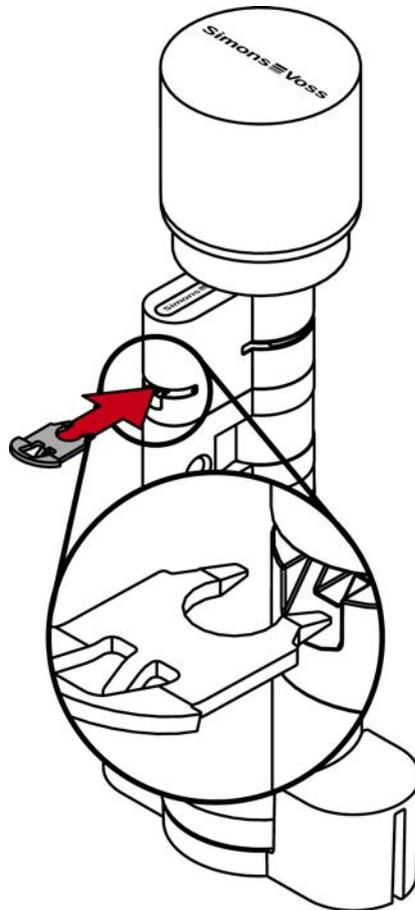
15. Setzen Sie den Zylinder in den Klemmblock ein, sodass der Profilzylinder und der Knauf bündig in den Aussparungen liegen.
