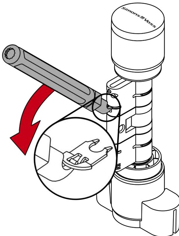
4. Ziehen Sie die Klammer vollständig aus dem Profilzylinder.
