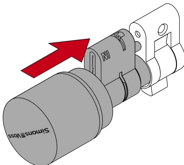
17. Setzen Sie die Klammer mit der Nase zur Stulpschraube wieder in den Schlitz des Profilzylinders ein und drücken Sie die Klammer mit dem Daumen fest, damit sie nicht mehr herausfallen kann.
