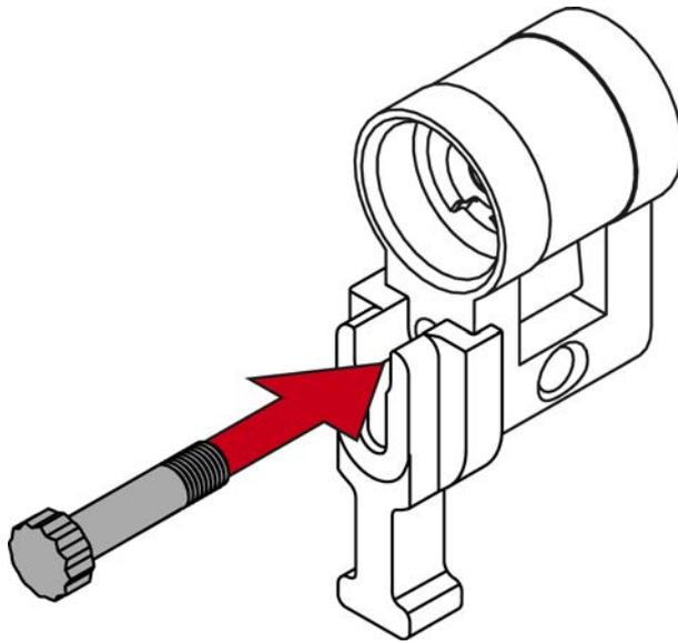
8. Stellen Sie die vorbereitete Zylinderhälfte in das Knauf-Montagewerkzeug.
