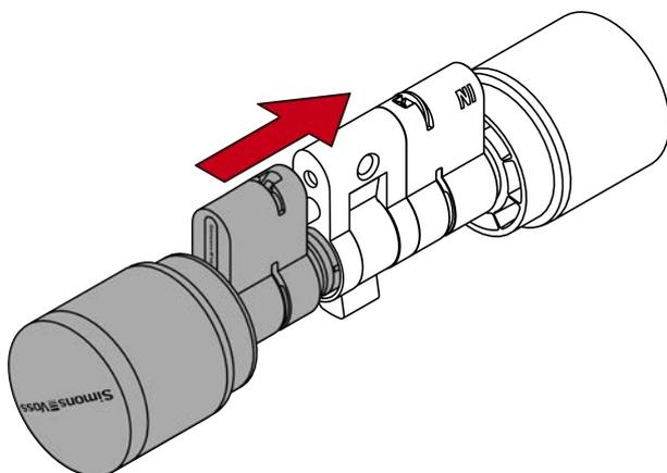
24. Setzen Sie die Klammer mit der Nase zur Stulpschraube wieder in den Schlitz des Profilzylinders ein und drücken Sie die Klammer mit dem Daumen fest, damit sie nicht mehr herausfallen kann.
