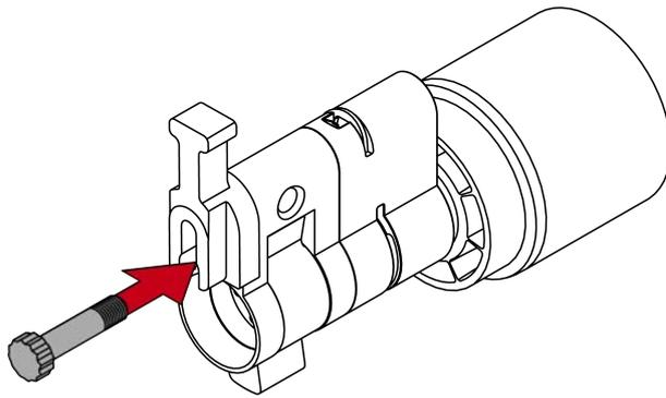
21. Stecken Sie eine Zylinderhälfte auf den Verlängerungsbolzen.
