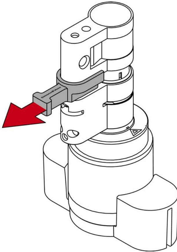
11. Schieben Sie die Zylinderteile vollständig zusammen.
