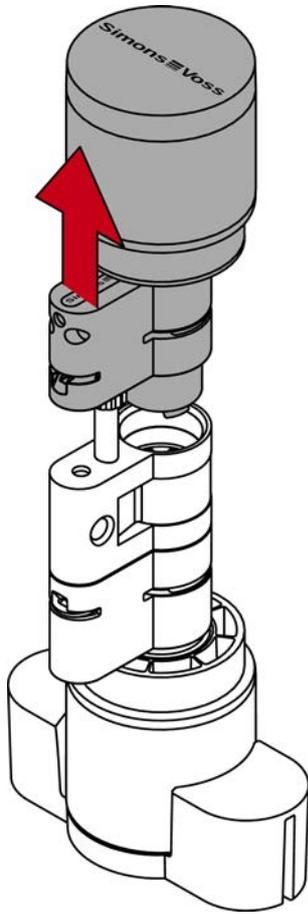
↳ Erste Zylinderhälfte ohne Mittelstück vorbereitet.
