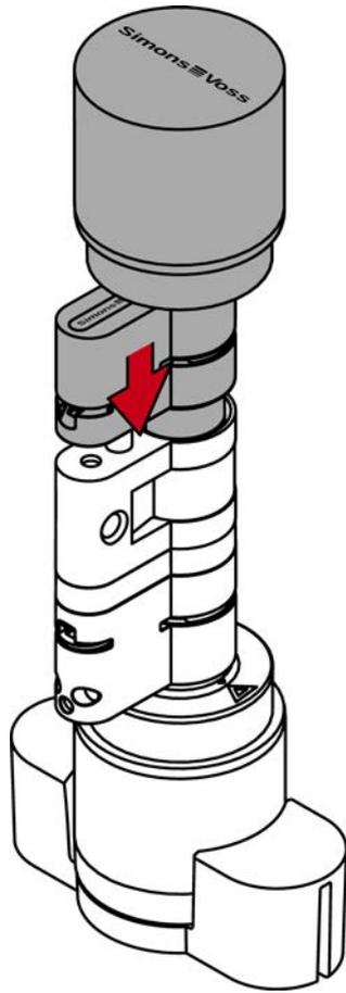
14. Setzen Sie die Klammer mit der Nase zur Stulpschraube wieder in den Schlitz des Profilzylinders ein.
