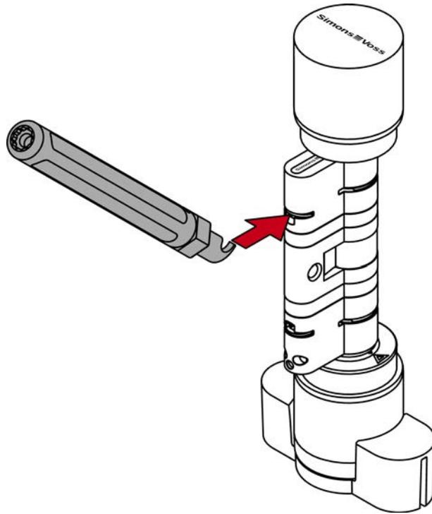
3. Hebeln Sie die Klammer aus dem Profilzylinder, indem Sie den Ausheber in die Mitte des Zylinders bewegen.
