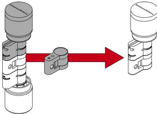
Aus einem AX-Comfortzylinder oder einem freidrehenden Zylinder können Sie mit einem speziellen Mittelstück einen Halbzylinder zusammensetzen.
