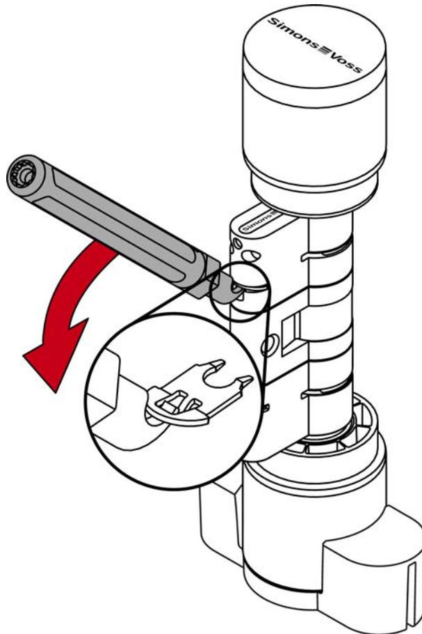
4. Ziehen Sie die Klammer vollständig aus dem Profilzylinder.
