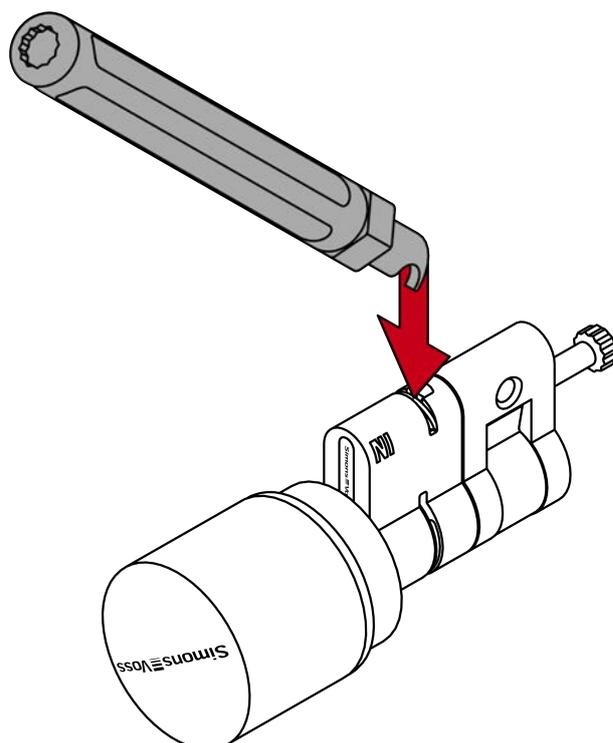
7. Hebeln Sie die zweite Klammer aus dem Profilzylinder, indem Sie den Ausheber in die Mitte des Zylinders bewegen.
