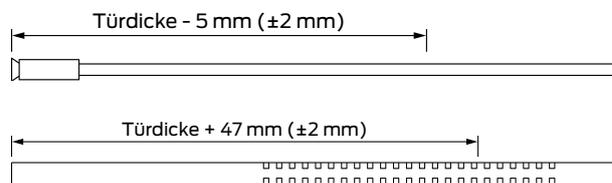
4. Für X: Kürzen Sie mit einer geeigneten Säge die Gewindestangen und den Vierkant.
